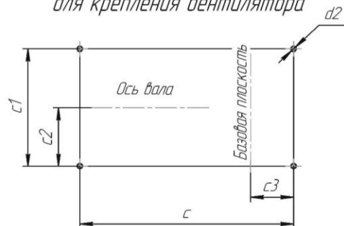
Схема расположения отверстий для крепления вентилятора
